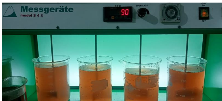
Gambar 1. Proses Koagulasi-Flokulasi dengan Jar Test
